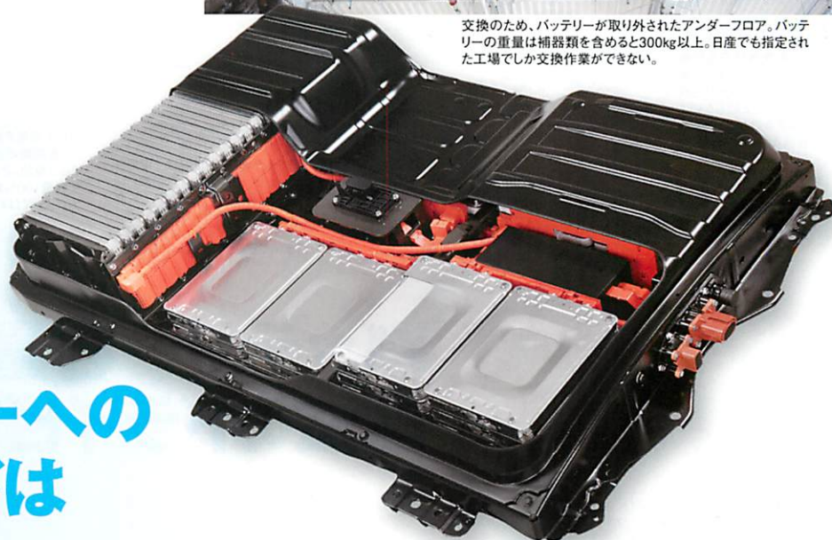
ひとつのモジュール(小箱)に入っているバッテリーセル数は24 kWhは4枚、30kWhは8枚と倍になり、モジュール数が半分にな った。コネクタ形状は同じだが、もし30kWhへ交換できたとし てもバッテリーマネジメントのプログラムの違いですべてのモジ ュールを認識しない可能性がある。
