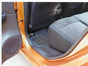
旧型と同じく床下にバッテリーがあるため、このセグメント（VWゴルフ相当の2BOX車）にしては後席のスペースに不満が残る。上げ底で、座ってみると何だか落ち着かない。
